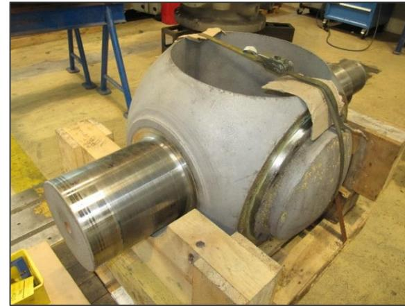
**2. Druckregler – Rissanzeigen und Reparatur, Fertigungsfehler**
