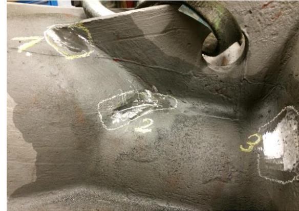
**3. Sicherheitsdrosselklappe – «unglückliches Design», hydraulische Anregung und Rissanzeigen**
